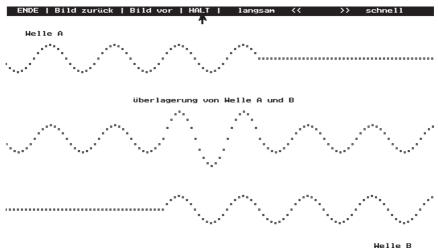
Abb. 4: Bildschirmkopie (Momentaufnahme) aus dem Programm zur Erklärung der Entstehung stehender Wellen als Überlagerung gegeneinanderlaufender Wellen gleicher Amplitude und Wellenlänge (Welle A läuft nach rechts, Welle B nach links). In der Computersimulation ist dort, wo sich die Wellenzüge überlagern, eindeutig eine stehende Welle zu erkennen.
