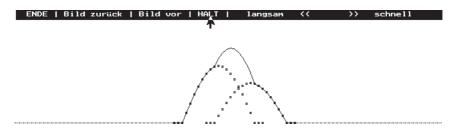
Abb. 3: Bildschirmkopie (Momentaufnahme) aus dem Programm zur Verdeutlichung des Prinzips der ungestörten Superposition. Die Störungen laufen gegeneinander, überlagern sich und laufen wieder auseinander.
