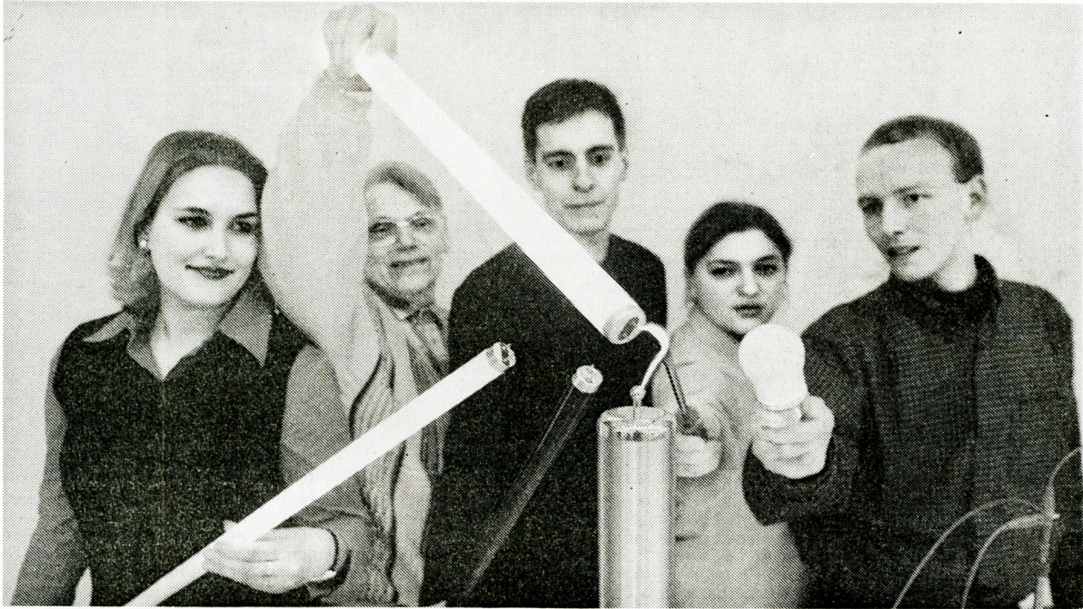
Ein Beispiel aus der Weihnachtsvorlesung: „Tesla-Transformator“, nennt sich der glänzende Zylinder in der Mitte, der mittels hochfrequenter Spannung Neonröhren zum Leuchten bringt und einen Lichtbogen zu einem Schraubenzieher erzeugt. F.: Windhorst
