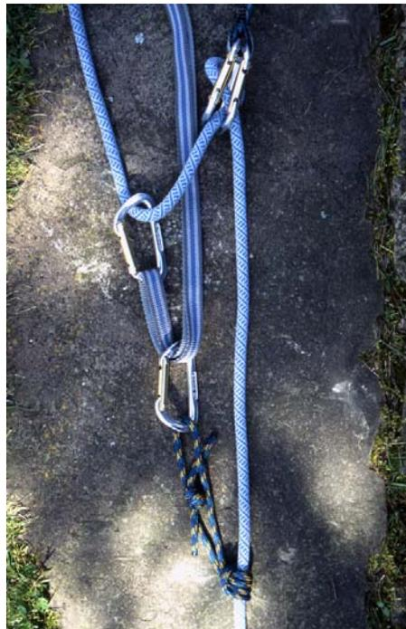
**Abb. 3:** Schweizer Flaschenzug mit Kraftumsetzung 1:5 im Modell (links) und am Berg (rechts).
