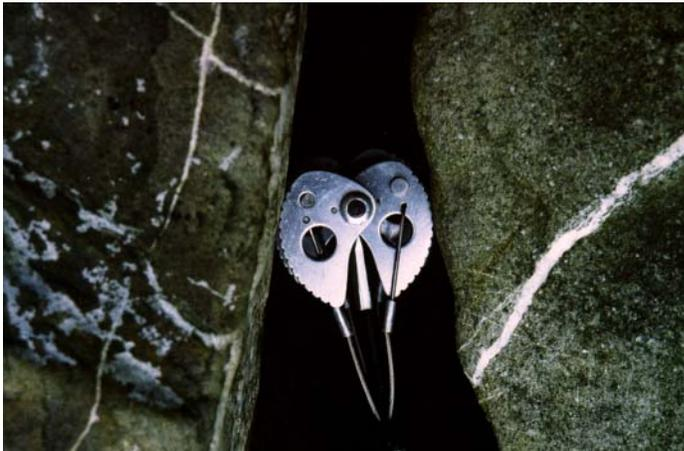
**Abb.10:** Beispiel für einen Friend als Befestigungshilfe in einem Spalt. Hier ist gezeigt, dass ein Friend sogar in einer nach unten sich öffnenden Spalte eine Klemmwirkung zeigt. Diese Art der Befestigung sollte allerdings beim Klettern aus Sicherheitsgründen vermieden werden.
