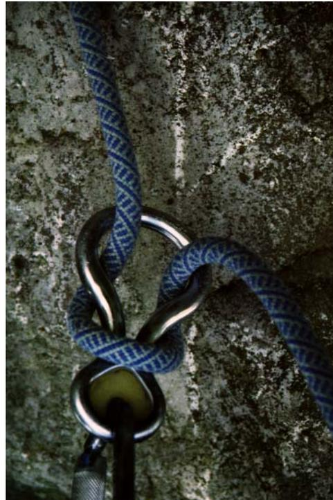
**Abb. 7:** Seilführung in Karbinern zur Verstärkung der Bremswirkung durch Reibung: 7a (links) Halbmastwurf; 7b (rechts) Achter.
