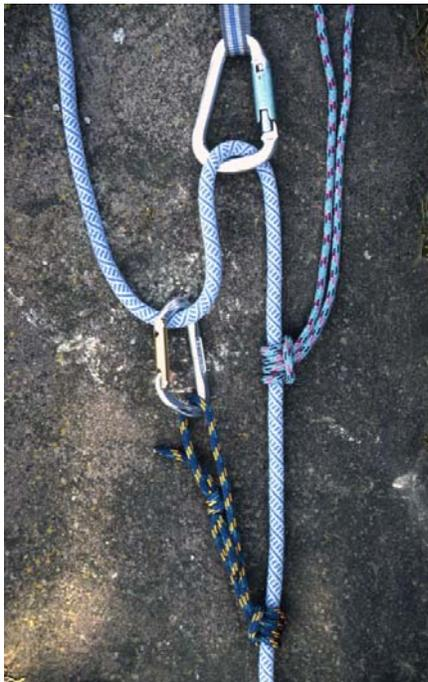
**Abb.2:** Schweizer Flaschenzug mit Kraftumsetzung 1:3 im Modell (links) und am Berg (rechts).
