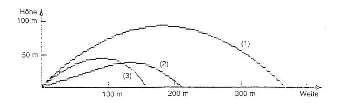
(1) ohne Luftwiderstand, (2) mit Luftwiderstand und Auftrieb, (3) mit Luftwiderstand.
